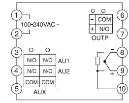
注 1: 热电偶应用补偿导线直接接入仪表后盖输入端子上, 中间不得转用普通导线连接, 并注意补偿导线型号与极性的正确。
