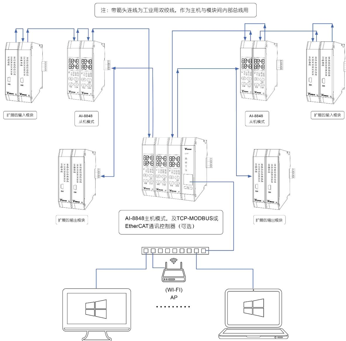
注：AI-8X48 的主机和从机及扩展模块的底部总线（包括 24V 电源及 RS485 通讯接口）不能直接连接，二者需要分开接线，这是因为主机的底部总线是与上位机或 TCP-MODBUS 或 EtherCAT 等通讯控制器做通讯用途，而从机及扩展模块的底部总线是作为主机向从机或输出类型的扩展模块传输输出值用途，二者不能并联。所有主机的扩展模块底部总线可以并联，但不同主机的扩展模块底部总线要分开连接。AI-8X48 从机模式下只作为输入采集和输出模块用途，自身 PID 调节功能会关闭，统一由主机进行 PID 调节及分配输入和输出资源。
